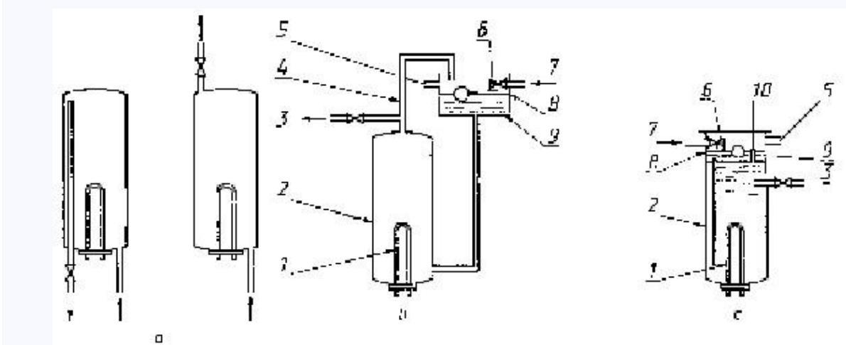
*1* - нагревательный элемент; *2* - бак; *3* - выходная труба; *4* - труба расширения; *5* - перелив; *6* - шаровой клапан; *7* - входное отверстие; *8* - уровень воды; *9* - резервуар; *10* - вентиляционное отверстие
