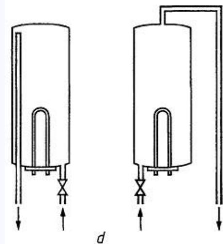
*a* - закрытый водонагреватель; *b* - водонагреватель, питаемый от отдельного резервуара; *c* - водонагреватель со встроенным резервуаром; *d* - водонагреватель со свободным сливом
