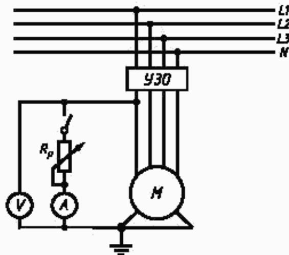
Рисунок В.1 — Схема проверки УЗО по методу 1
