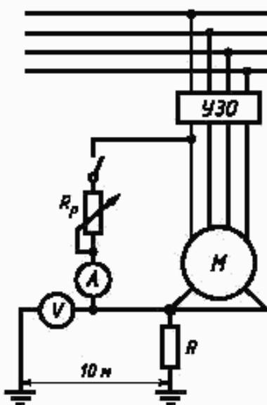
Рисунок В.3 — Схема проверки УЗО по методу 3
