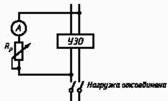
Рисунок В.2 — Схема проверки УЗО по методу 2
