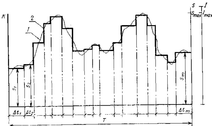
1—исходный график нагрузки; 2—эквивалентный прямоугольный график нагрузки
