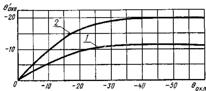
1—для трансформаторов с видами охлаждения М и Д; 2—для трансформаторов с видом охлаждения ДЦ
