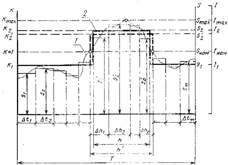
$I$ —исходный график нагрузки; 2—двуихстушенчательный прямоугольный график нагрузки
