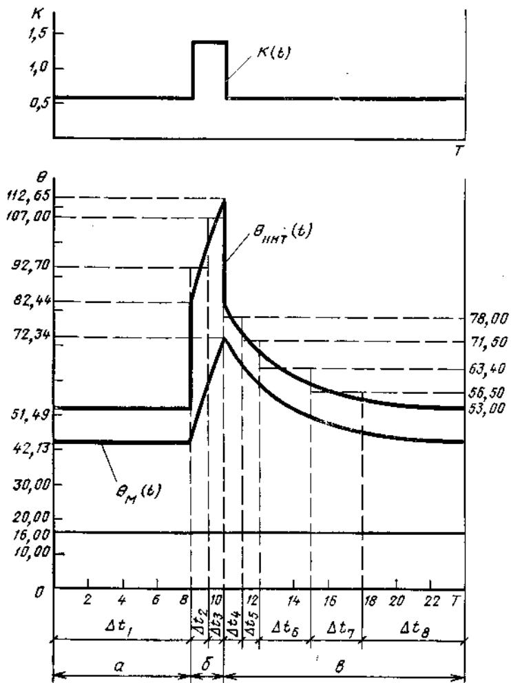
1.3. Относительный износ витковой изоляции  $F$  за суточный график нагрузки, согласно формуле (16), является суммой относительных износов  $F_i$  по каждому интервалу  $\Delta t_i$ , на которые разделяется график  $\Theta_{\text{внт}}(t)$ , в соответствии с указаниями п. 2.4.2.
