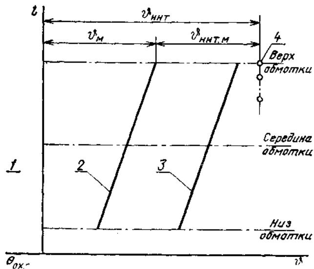
1 — линейный размер по вертикали бака и обмотки;  $\theta$  — превышение температуры; I — охлаждающая среда; 2 — изменение температуры масла в баке по высоте обмотки; 3 — изменение средней температуры частей (катушек) обмотки по ее высоте; 4 — наиболее нагретая точка обмотки
