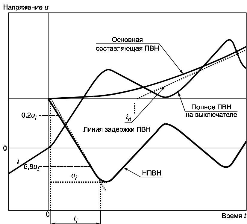
Рисунок 6 — Начальная часть переходного восстанавливающегося напряжения (НПВН)
