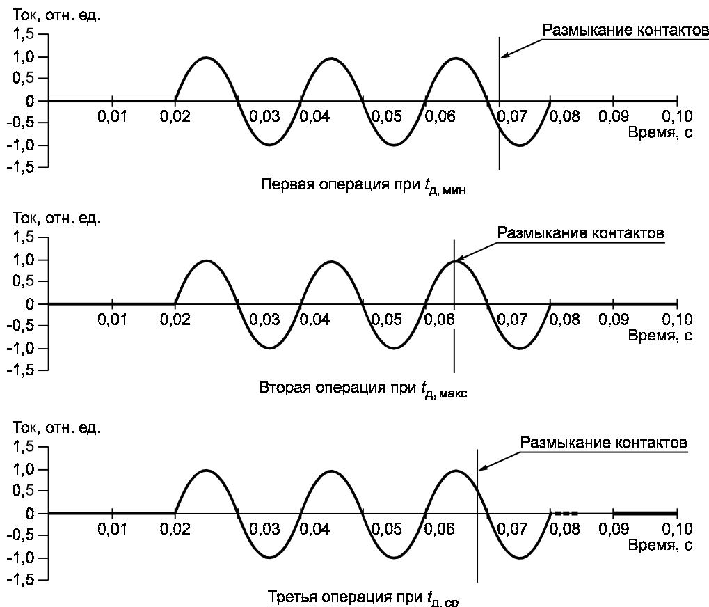
Рисунок 11 — Регулирование момента размыкания контактов относительно фазы тока при однополюсном отключении симметричного тока в режимах T10, T30, T60, T100s, Tcr1, Tcr2, Tcr3 выключателями с  $U_{\text{ном}} \leq 35$  кВ
