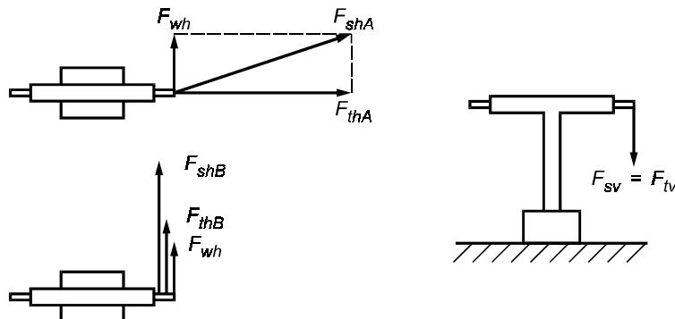
$F_{thA}$  — горизонтальная сила тяжения проводов (направление А);  $F_{thB}$  — горизонтальная сила тяжения проводов (направление В);  $F_{tv}$  — вертикальная сила тяжения проводов (направление С);  $F_{wh}$  — горизонтальная сила давления ветра на выключатель, покрытый льдом;  $F_{shA}$ ,  $F_{shB}$ ,  $F_{sv}$  — нормированная статическая нагрузка на выводы (результатирующие силы)
