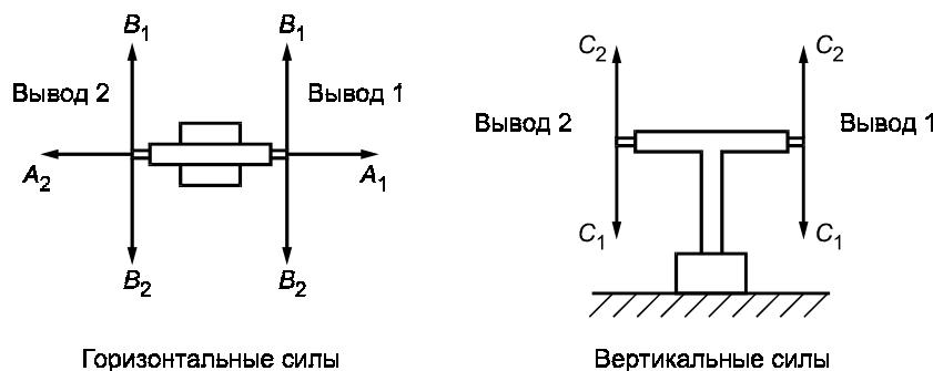
Горизонтальные силы  $F_{shA}$  и  $F_{shB}$  прикладываются в направлениях  $A_1$ ,  $B_1$  и  $B_2$  — для вывода 1 и в направлениях  $A_2$ ,  $B_1$  и  $B_2$  — для вывода 2.
