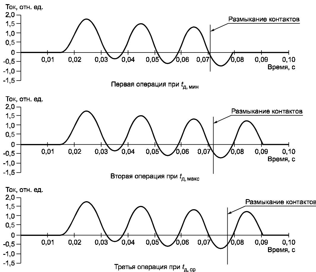
Рисунок 14 — Регулирование моментов инициирования тока и размыкания контактов при однополюсном отключении тока в режиме Т100а выключателями с  $U_{\text{ном}} \geq 110$  кВ
