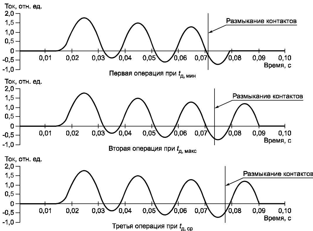
Рисунок 12 — Регулирование моментов инициирования тока и размыкания контактов при однополюсном отключении тока в режиме T100а выключателями с  $U_{\text{ном}} \leq 35$  кВ
