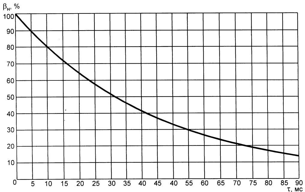
Рисунок 3 — Содержание апериодической составляющей в процентах
