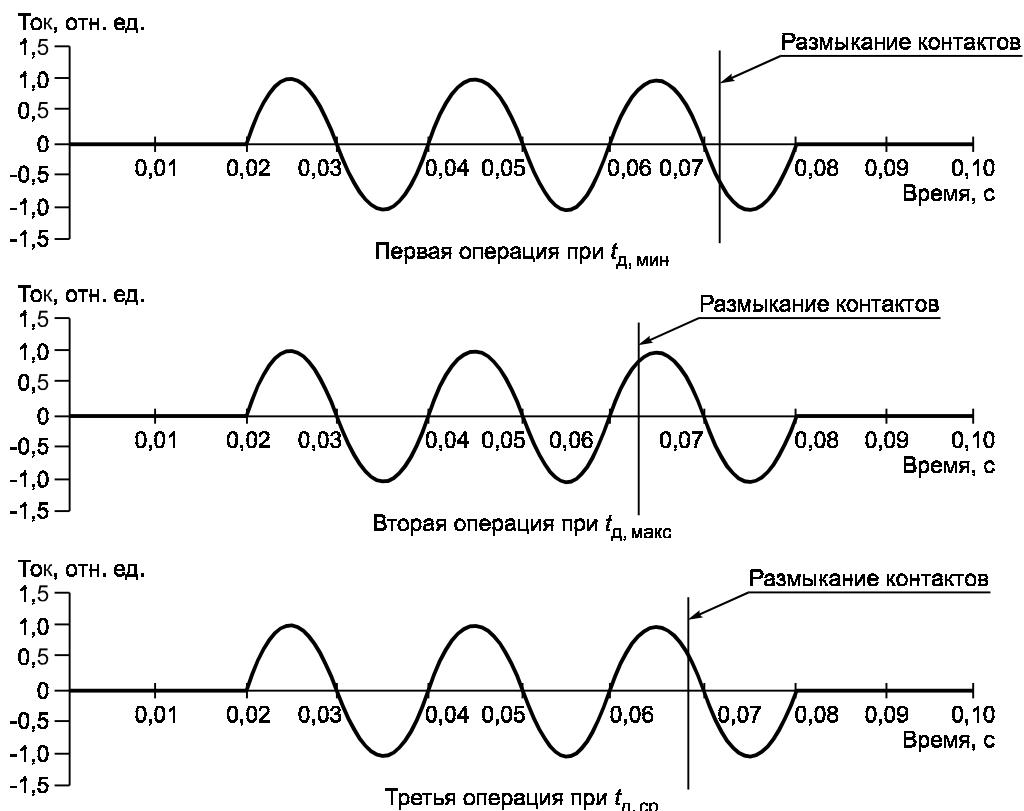
Рисунок 13 — Регулирование момента размыкания контактов относительно фазы тока при однополюсном отключении симметричного тока в режимах T10, T30, T60, T100S, Tcr1, Tcr2, Tcr3, OP2, L90, L75, L60 выключателями с  $U_{\text{ном}} \geq 110$  кВ
